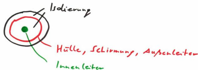
Skizze Aufbau KoAx im Querschnitt
