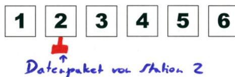
Station 2 sendet ein Datenpaket aus. Das Paket wandert bidirektional im Kabel Richtung Endwiderstand.
